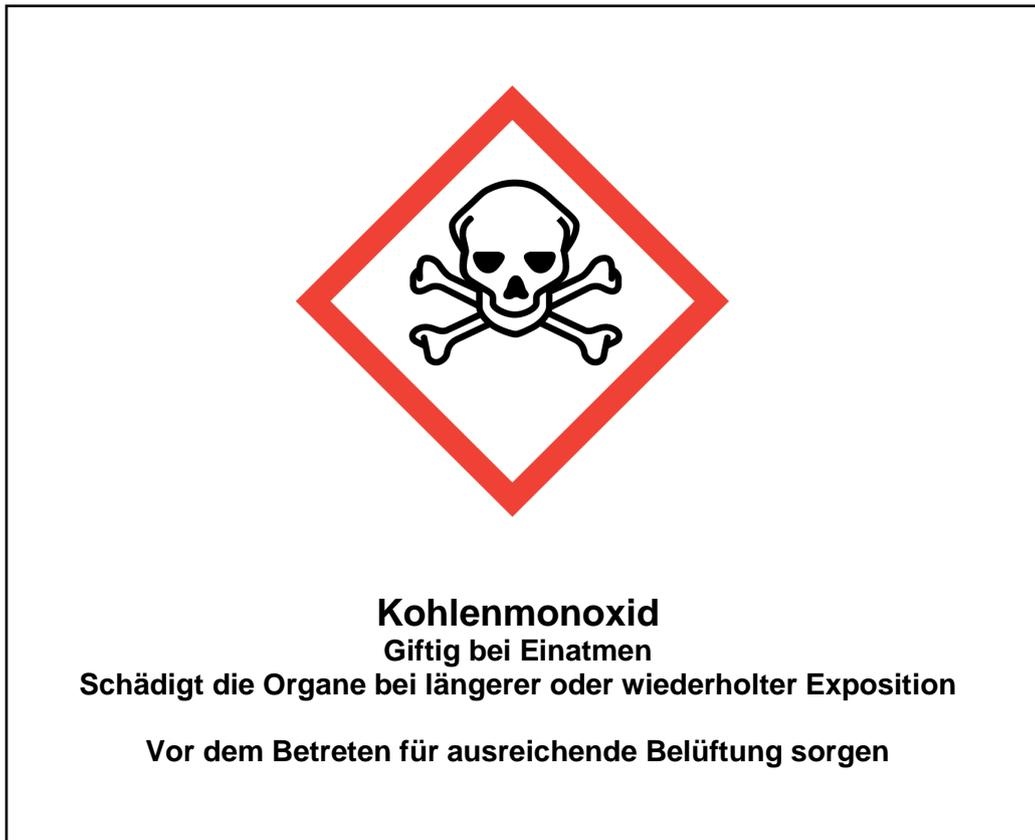
(Kennzeichnung bezüglich Kohlenmonoxid mittels Warnschild des DEPV entspricht nicht GefStoffV und ASR A1.3)
